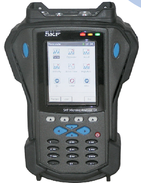
SKF Microlog GX 是一台具完整性、雙頻道，包含路徑與非路徑之高性能的攜帶式資料收集器/FFT 分析儀
