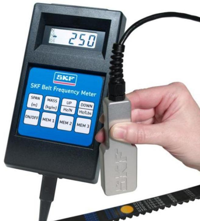
**SKF 紅外線皮帶張力計**由手持數位量測計及光學感測器組成，以光學感應方式量測皮帶震動頻率，適用於時規皮帶、三角皮帶以及**動力傳送皮帶**等各種工業用皮帶，幫助您快速，可靠，精確的量測皮帶張力
